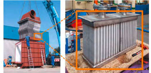
EFFEKTIV. Neuer Hochleistungs-Rekuperator (rechts) – gleiche Leistung bei 25-fach geringerer Baugröße.
