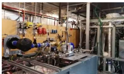
Der Prüfstand mit dem MultiSchiBZ-Feststoff-(SOFC) Brennstoffzellensystem im OWI-Labor. Foto: OWI
